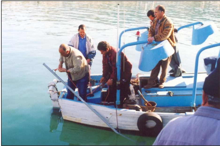
Photo 5 : Mode de montage du "Tube Dauphin" sur la barque à lumière
