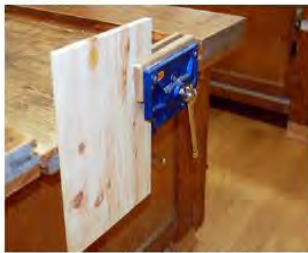
けずりやすい板の低い位置を万力で固定
