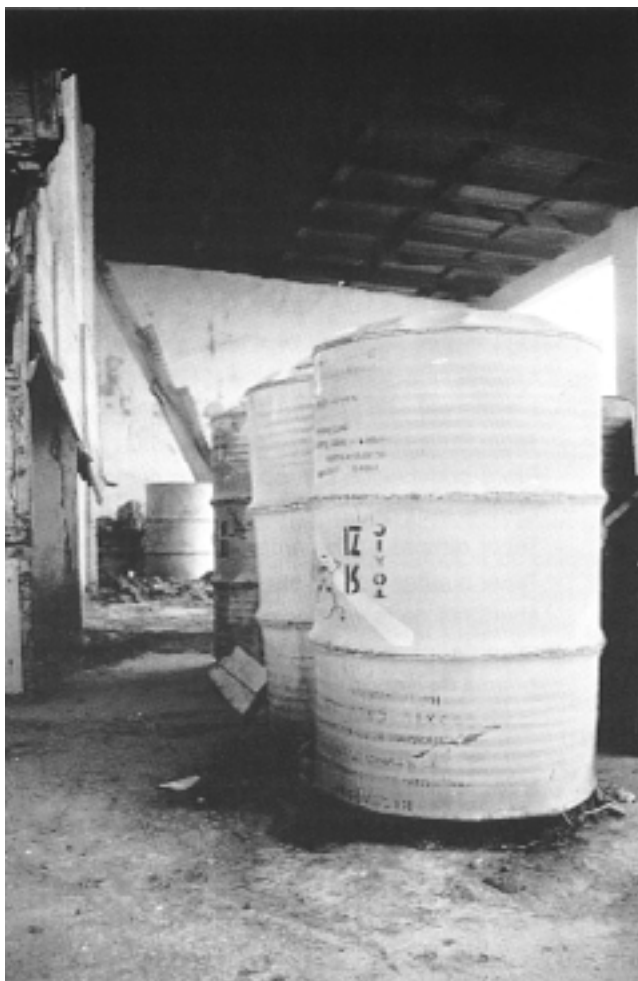
FIGURE 6 Fûts gonflés qui ont laissé échapper des pesticides liquides sur le sol car les fonds ont cédé sous l'effet de la rouille et de la simple pression de produits chimiques
