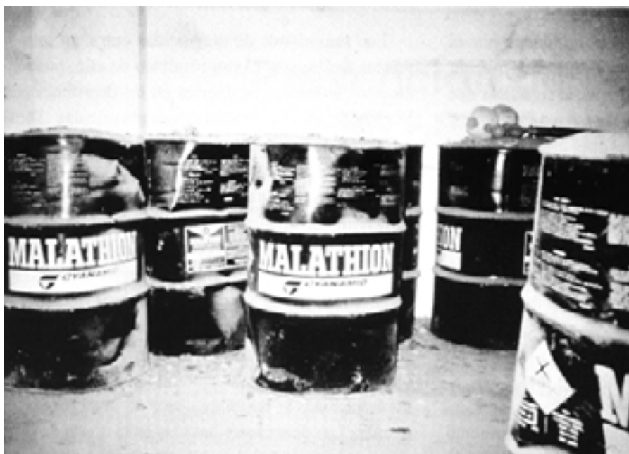
FIGURE 4 Détail d'une expédition de malathion envoyée par un donateur et maintenant périmée. Certains fûts ont fui et leur contenu s'est répandu sur le sol, tandis que d'autres sont gonflés, de sorte que le haut des fûts est bombé
