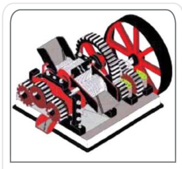
Figura 57. Molino horizontal de tres mazas con transmisión incorporada en la misma base
