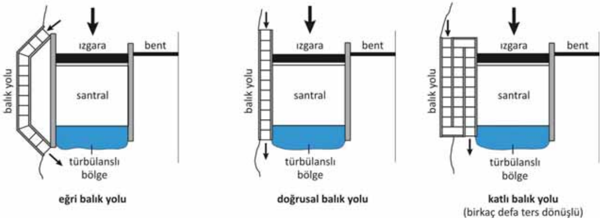
Şekil 5.2: Havuzlu geçitler (üstten görünüş) (Larinier, 1992a'dan değiştirilmiş)
