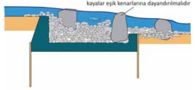
Şekil 4.7: Yapay düşünün pürüzlü meyilli tabana dönüştürülmesi
