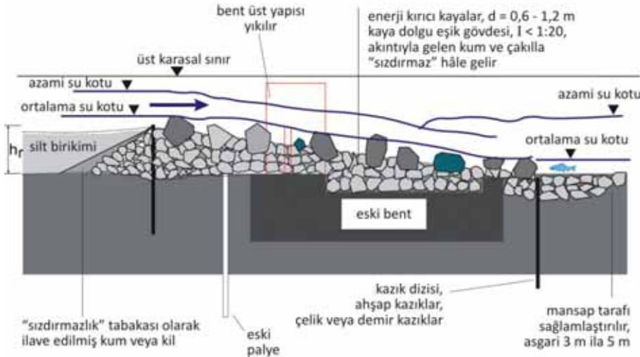
Şekil 4.8: Regüle edilebilen bir bendin koruma eşiği hâline dönüştürülmesi
