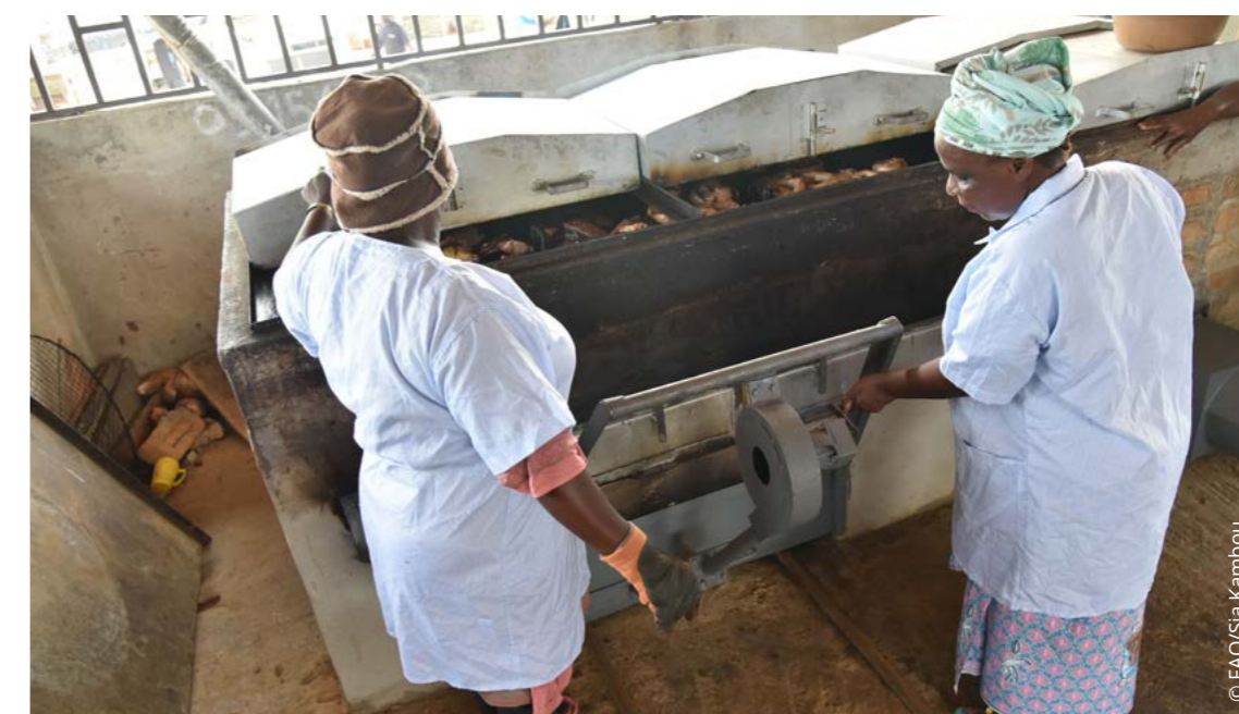
Figure 10. Four amélioré utilisant la technique FAO Thiaroye
