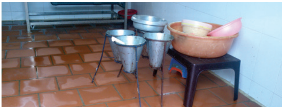
Cônes de saignée bien nettoyés dans un abattoir à petite échelle.
