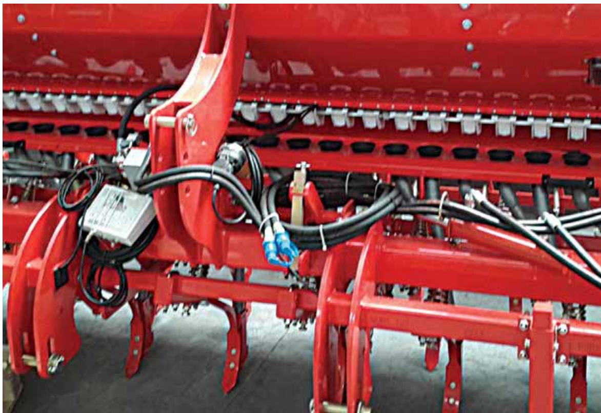
Рисунок 31. Сеялка с долотовидными или анкерными сошниками
