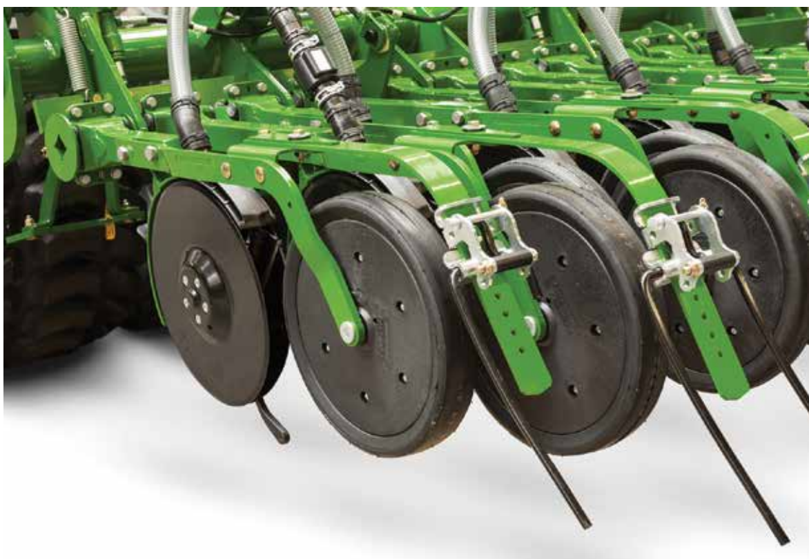
Рисунок 30. Двухдисковые сошники со смещенными дисками
