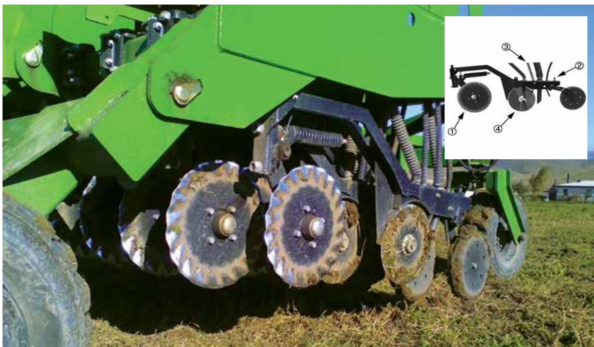
Рисунок 22. Сеялка нулевого сева Great Plains 1007NT: 1 – режущий диск (кольтер), 2 – регулятор глубины заделки семян, 3 – механизм очистки диска от грязи, 4 – дисковый сошник
