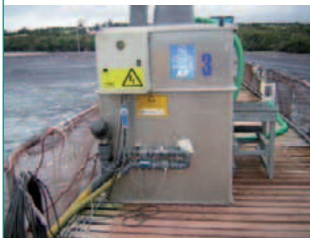
РИСУНОК 13 Автоматический бункер-кормораздатчик с системой сбора кормов (Чили)
