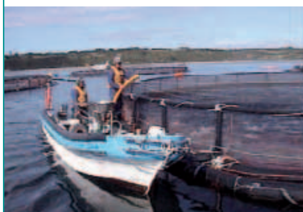
РИСУНОК 7 Процесс кормления в пластиковых садках с использованием приспособленного водного насоса
