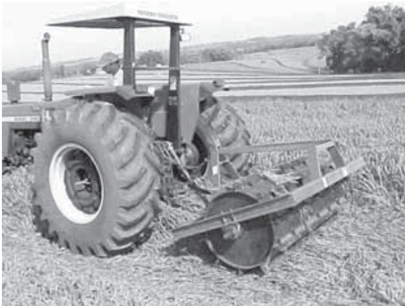
Lámina 65 Cuchillo rotativo tirado por un tractor que trabaja sobre avena.
