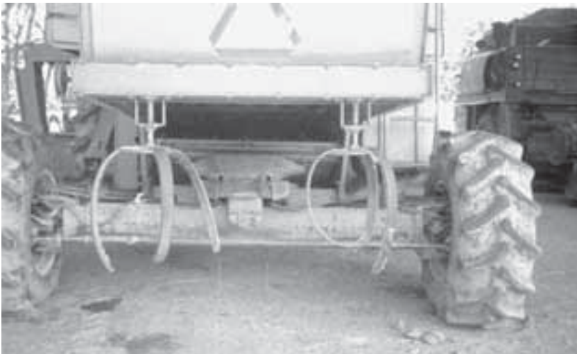
Lámina 63 Un par de distribuidores de paja a golpe en la parte posterior de una cosechadora. Este equipo no distribuye la paja fina.
