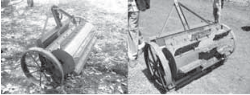
Lámina 64 Cuchillos rotativos para tracción animal: con cuchillos en todo su ancho (izquierda) y con cuchillos cortos (derecha).
