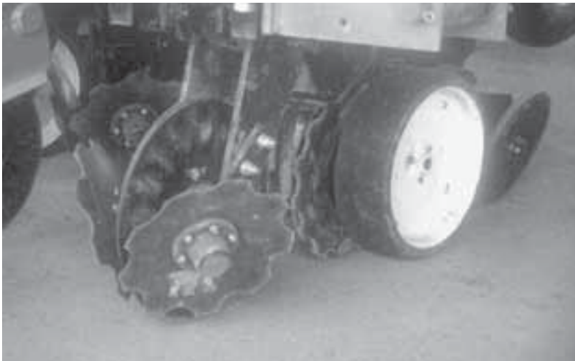
Lámina 70 Un par de limpiadores de discos, con muescas, angulados, diseñados para empujar los residuos a los dos lados y delante del abresurcos.
