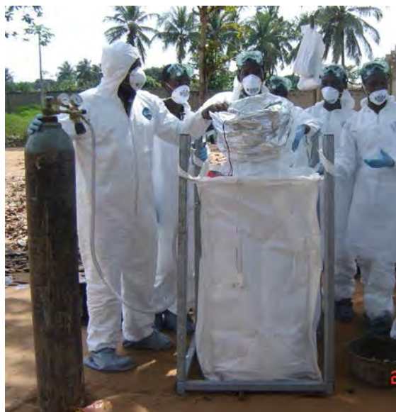
FIGURE 10 « Influenza Containment System (ICS) » pour abattage zoo-sanitaire des volailles dans la localité d'Agbata
