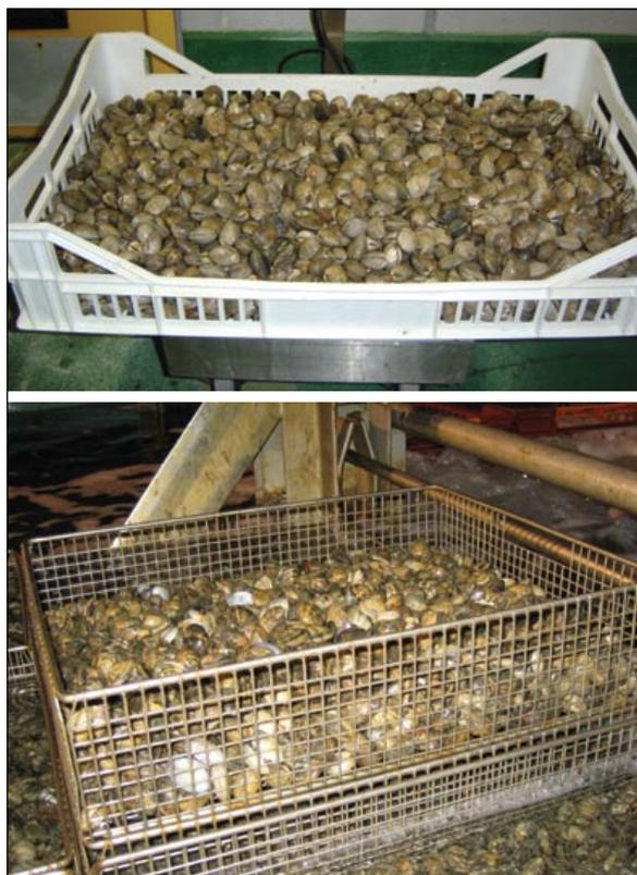
Figure 5.6: Exemples de paniers appropriés pour les bassins de purification
