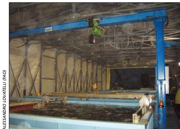
**Figure 8.1:** Système mécanique de chargement et de déchargement des bassins
