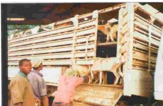
Зураг.32: Хонь/ямааг тээвэрлэх зориулалттай давхар тавцантай ачааны машин
