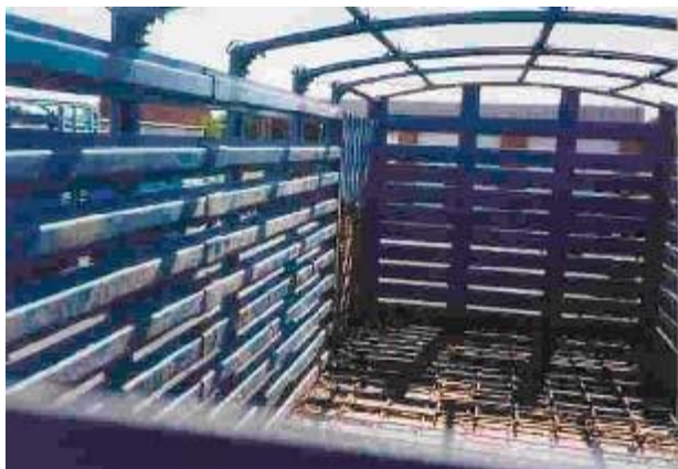
Зураг 29: Үхэр тээвэрлэх зориулалттай авто тээврийн хэрэгсэл (үхэр хальтирахаас сэргийлж ачааны машины тэвшинд модон хөндлөвч хаджээ.)
