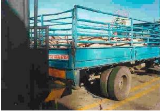
Зураг.34: Гахай тээвэрлэх агааржуулалт сайтай ачааны машин. Нарны халалтаас хамгаалахын тулд машинд хучлага (дээвэр) хийх шаардлагатай.
