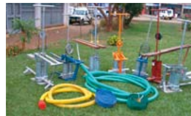
Modelos de bombas a pedal (desde la izquierda) – Pedales de metal/polea de Balaji; MG Industries/polea; Advait/pedales de madera; Pedales de metal/polea de Zim; MG Industries/engranaje y cadena de bicicleta; Pedales de madera/polea de goma de Pipeco, Mw; Pedales de metal/pivot de Balaji (Foto: Z. Jere, Total Landcare Malawi & H. Phombeya, Land Resource Centre, Malawi)
