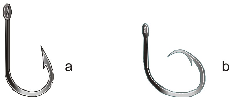
Figure 21: (a) hameçon en forme de J utilisé pour la pêche de l'espadon et du germon; (b) hameçon en forme de G utilisé principalement pour la pêche du thon rouge.
