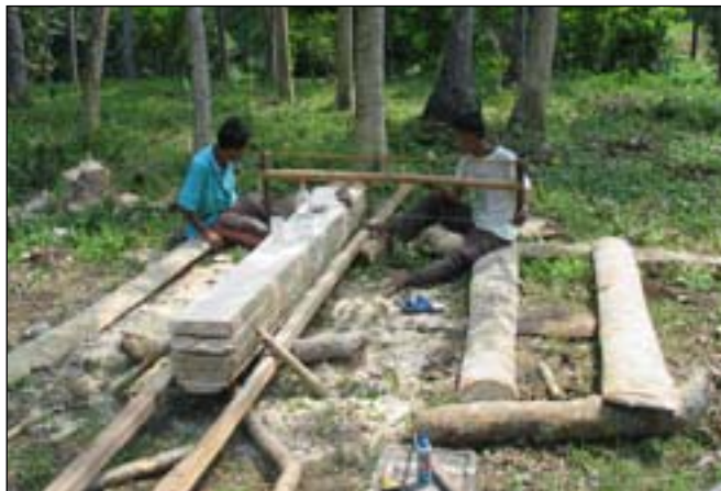
Scie manuelle manœuvrée par deux bûcherons utilisée pour la coupe primaire de grumes dans la forêt
