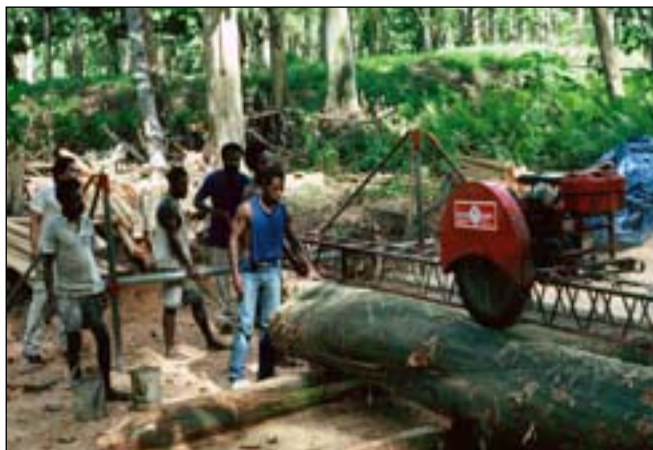
Fonctionnement d'une scierie mobile dans la forêt, Papouasie-Nouvelle-Guinée
