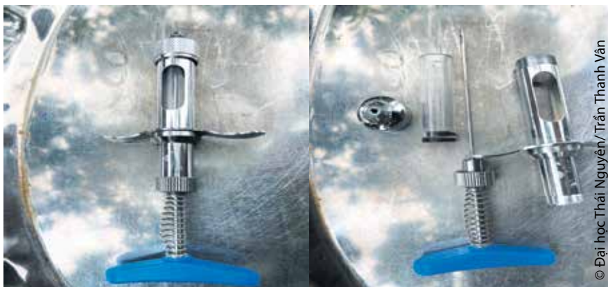
Hình 51. Bơm tiêm tự động chủng đậu gà
