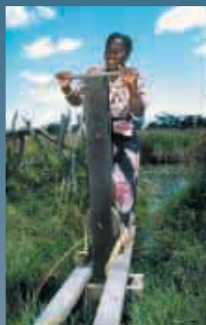
Un agricoltore dello Zambia che aziona una pompa a pedali
