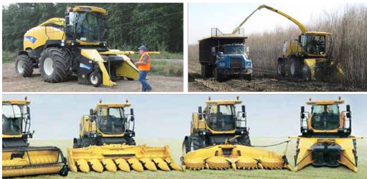
Fig. 1: Arriba a la izquierda: Una New Holland FR 9060 cosechadora de forraje con un cabezal 130 FB anexo a la misma, se está preparando para una cosecha de álamo híbrido en Western Oregon. Arriba a la derecha: Un FR-9080 cosechadora de forraje que opera en una plantación de sauces en Auburn, Nueva York en noviembre de 2012. Abajo: Los ejemplos de cabezales disponibles para el FR 9000- serie de cosechadoras de forraje, incluyendo la cabecera de monte bajo 130 FB en el extremo derecho.
