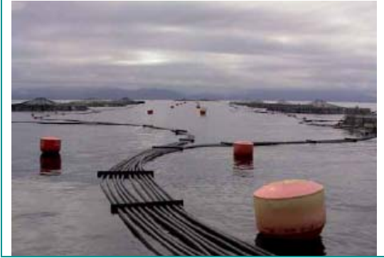
图12 利用压缩空气将饲料从料斗传到各个网箱
