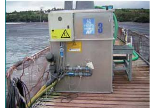
图13 具有饲料收集系统的自动喂食料斗（智利）
