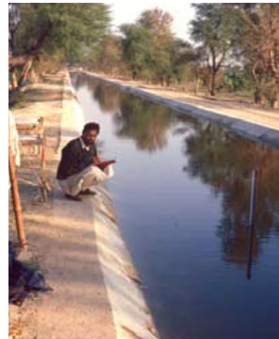
Mesure des pertes par infiltration à Fordwah-Sadiqia, Panjab, Pakistan.
