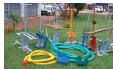
Modèles de pompes à pédales (à partir de la gauche): pédales/poulie métalliques Balaji; poulie MG Industries; pédales en bois Advait; pédales/poulie métalliques Zim; pignon et chaîne de bicyclette MG Industries; pédales en bois/poulie en caoutchouc Pipeco MW; pédales/pivot métalliques Balaji (Photo: Z. Jere, Total Landcare Malawi & H. Phombeya, Land Resource Centre Malawi)
