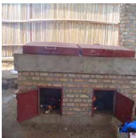
Figure 5. Four amélioré de fumage du poisson issue d'un prototype traditionnel
