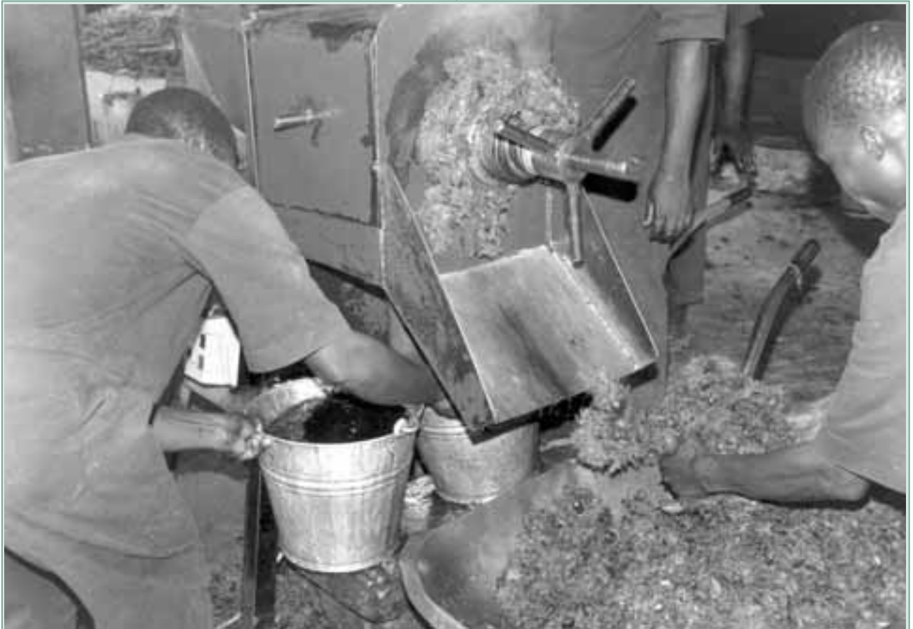
FIGURA 10 Extracción de aceite de palma a gran escala en Benín mediante una prensa de tornillo.
